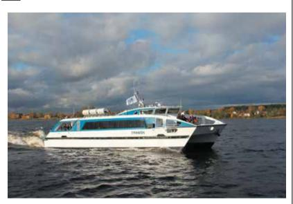
Владимир Середохо. Судно предназначено для транспортировки 150 пассажиров. Длина судна — 25,7 м, ширина — 9,03 м, осадка — 1,5 м. Дальность плавания судна составляет 1000 км. Максимальная скорость — 29,5 узлов. Катамаран может эксплуатироваться при высоте волны — 2 м (мореходность — 4 балла)
