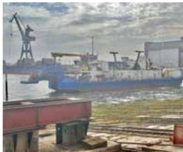
*Основные характеристики проекта: длина корпуса — 50 м; ширина корпуса — 11,88 м; высота борта — 2,97 м; осадка средняя с полным запасом топлива — 1,3 м; максимальная глубина выработки грунта — 10 м; минимальная глубина выработки грунта — 2 м; производительность земснаряда — 900 куб. м/ч.*
