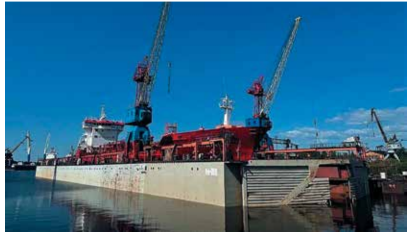
Доковый ремонт судна. Фото с сайта ЦС «Звездочка»
