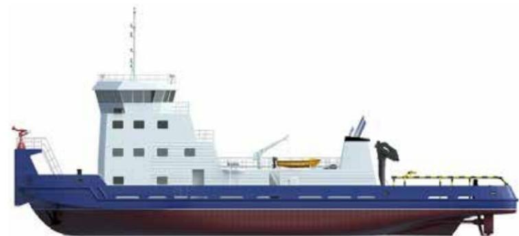
Характеристики буксира-толкача проекта 00443: габаритная длина — 47 м; габаритная ширина — 14 м; высота борта — 3,5 м; осадка — 2,3 м; экипаж/мест — 10/12 человек; мощность главных двигателей — 2×1000 кВт; скорость хода — не менее 20 км/ч; автономность плавания — 12 суток.
