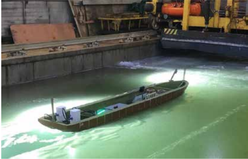
На фото: ледовые испытания модели НЭС; источник: ИАА «ПортНьюс»
